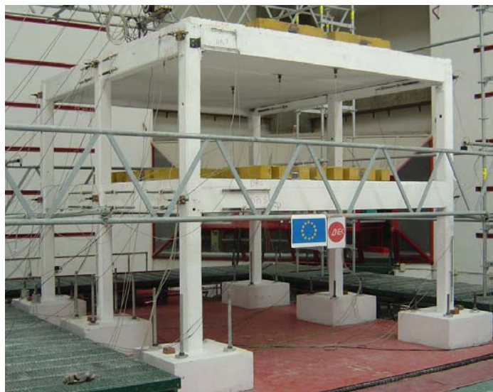
Figura 1: Vista geral da estrutura ensaiada em mesa sísmica.
